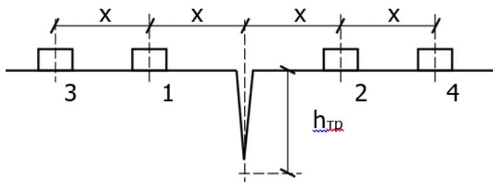
Сначала датчики устанавливаются на точки 1-2 схемы (трещина находится посередине, т.е.  $l=2x$ ) и измеряется время  $t_1$ , затем датчики устанавливаются на точки 3-4 (трещина - посередине  $l=4x$ ), измеряется время  $t_2$  и автоматически вычисляется глубина трещины по формуле (2):
