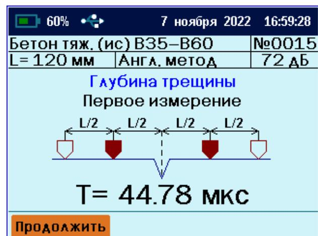
«Английский метод» измерения глубины трещины
