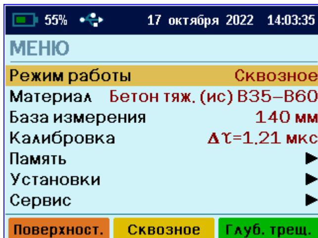
При выборе режима измерения глубины трещины пункт главного меню «**Материал**» изменяется на «**Датчик**» для выбора типа используемого датчика поверхностного или сквозного прозвучивания.
