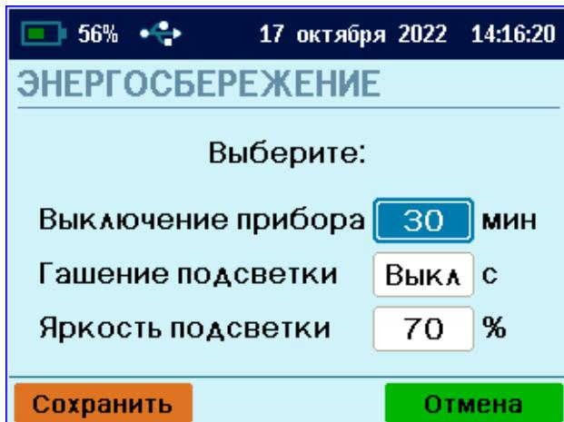
**Примечание** - При выборе значения яркости дисплея следует иметь в виду, что при увеличении яркости возрастает потребляемая мощность прибора и, следовательно, снижается время работы от аккумулятора. Продолжительность работы до разряда аккумулятора при яркости 30 % больше, чем при 100 % примерно в два раза. Не рекомендуется устанавливать значение яркости дисплея более 80 %, т.к., в данном случае, при незначительном увеличении яркости значительно увеличивается потребление энергии прибором.
