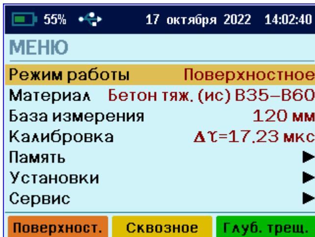
В верней части дисплея прибора во всех режимах работы выводится строка статуса, в которой отображается состояние заряда встроенного аккумулятора, подключение к USB-порту компьютера или к внешнему источнику питания, текущее время.
