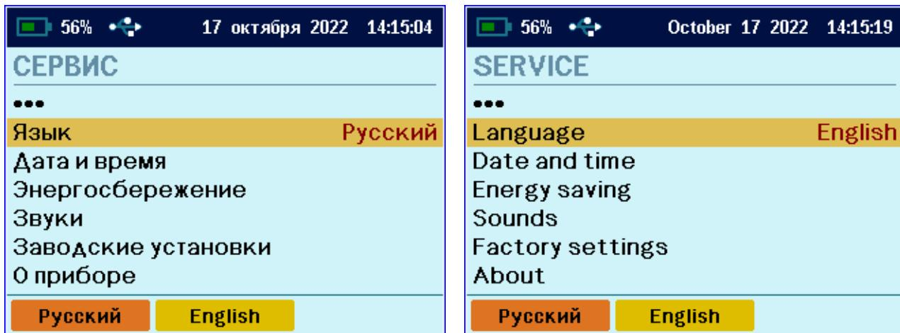
«Дата и время» - Установка даты, времени и коррекция хода внутренних часов прибора.
