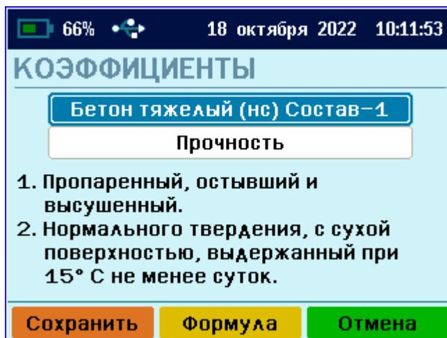
При выборе данного материала, нажав программную кнопку «**Коэф-ты**», для каждого из составов можно получить информацию о состоянии бетона и виде заданной в приборе характеристики.
