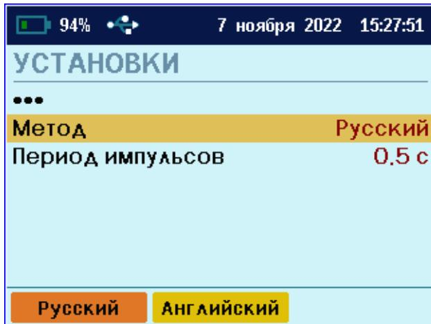
**«Период импульсов»** - Установка периода следования зондирующих импульсов от 0,2 до 2,0 с.
