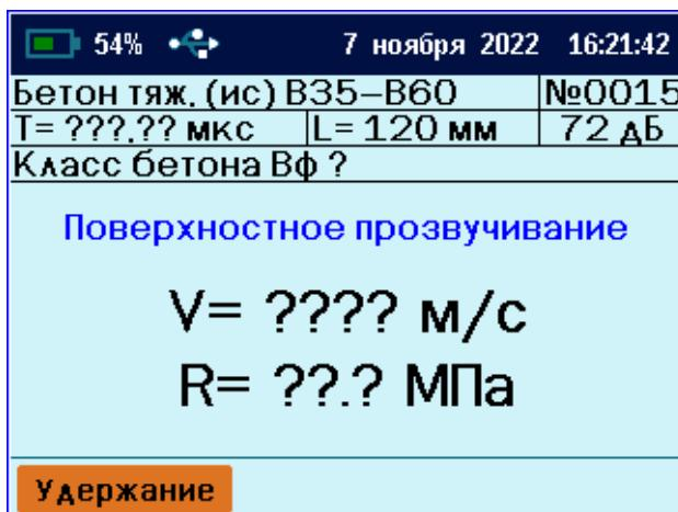
Если измеренное время выходит за допустимый диапазон измерения или сигнал отсутствует вследствие нарушения акустического или электрического контактов, цвет знаков меняется на красный.
