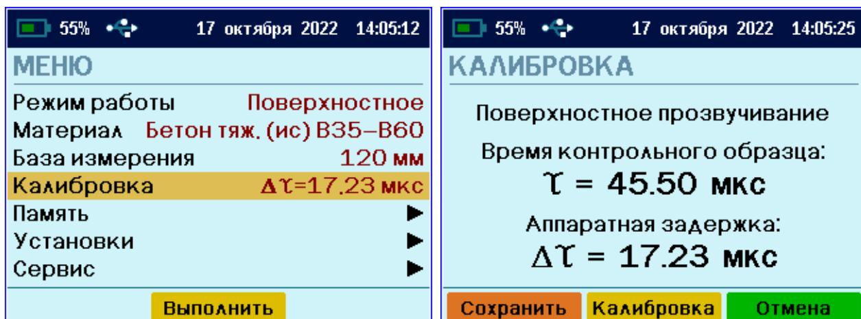
**Для датчика поверхностного прозвучивания:** Установить датчик на контрольный образец из оргстекла, удерживать датчик неподвижным в плоскости перпендикулярной к поверхности образца и прижать с усилием 5-10 кг.
